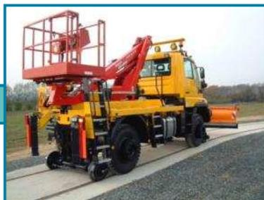
Nacelle élévatrice et stabilisateurs hydrauliques
