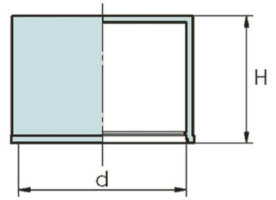
"Cape pour tube s'adaptant parfaitement au diamètre extérieur du tube
