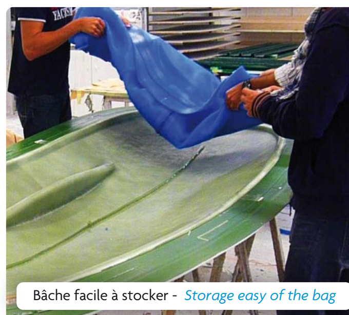
Bâche adaptable à différentes épaisseurs de renforts Vacuum bag used with different thickness of fibre
